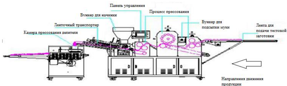
Рис3 Схематичное отображения прохода тестовой заготовки.
